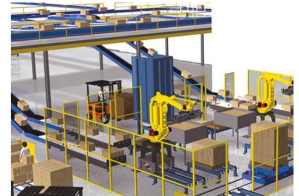
รูปแสดง Palletizer Robot แบบ แขนเดี่ยวหลายแกน (Arm Robot)
