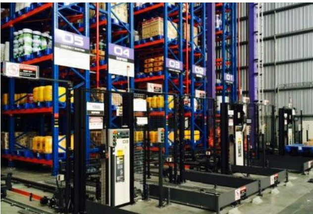
ระบบจัดเก็บและดึงข้อมูล อัตโนมัติ (AS / RS)
